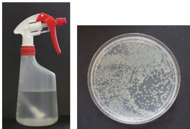
図1. ノズル式容器中の0.02%ベンザルコニウム塩化物の*Burkholderia cepacia*(セパシア菌)汚染例
